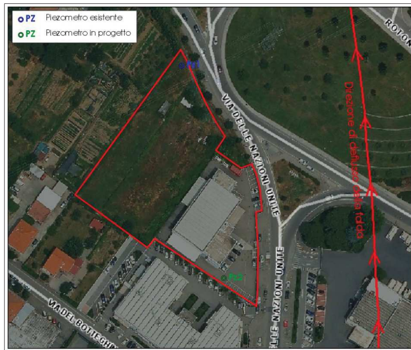
Rete monitoraggio acque sotterranee con ubicazione piezometro in progetto (da documentazione).
