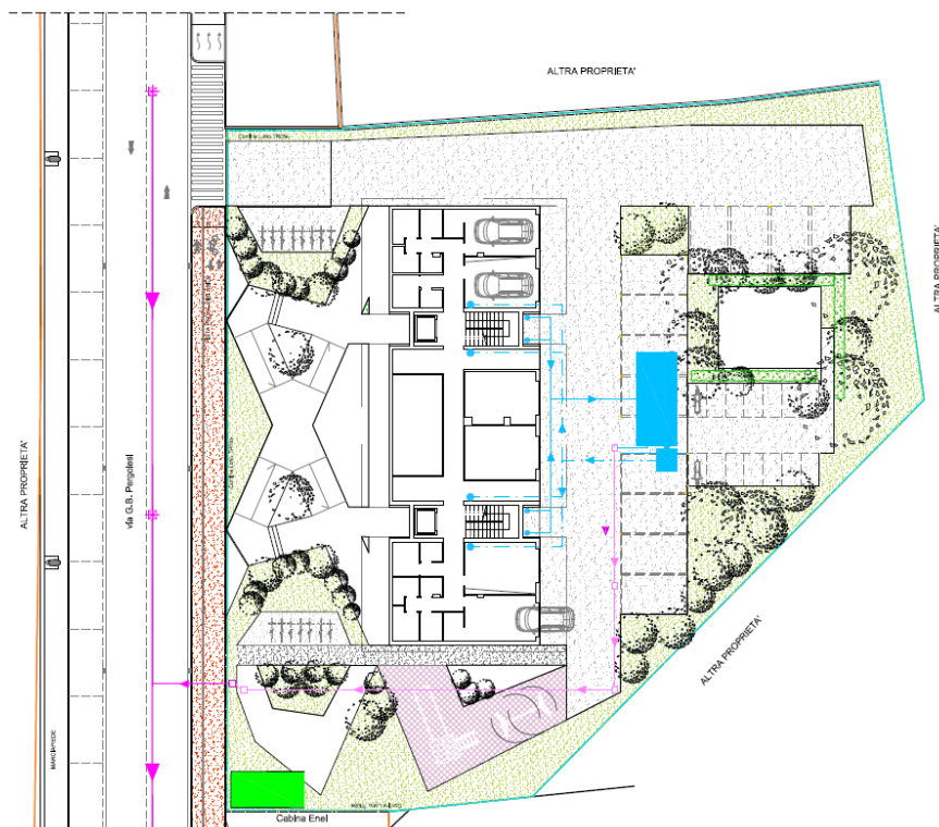
Serbatoio interrato capacità mc. 33,00
