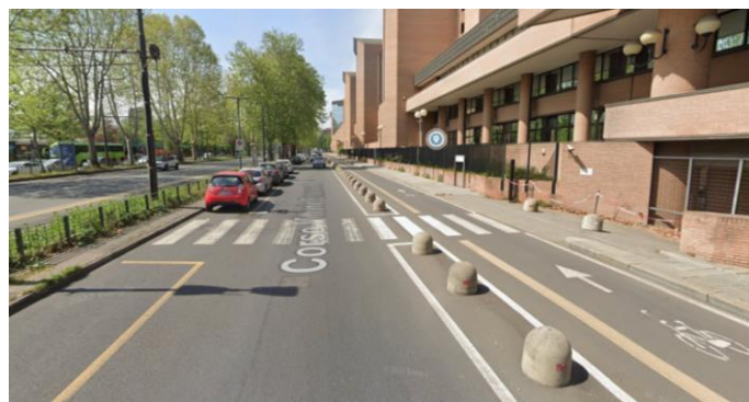
Figura 3 Esempi di pista ciclabile in sede propria
