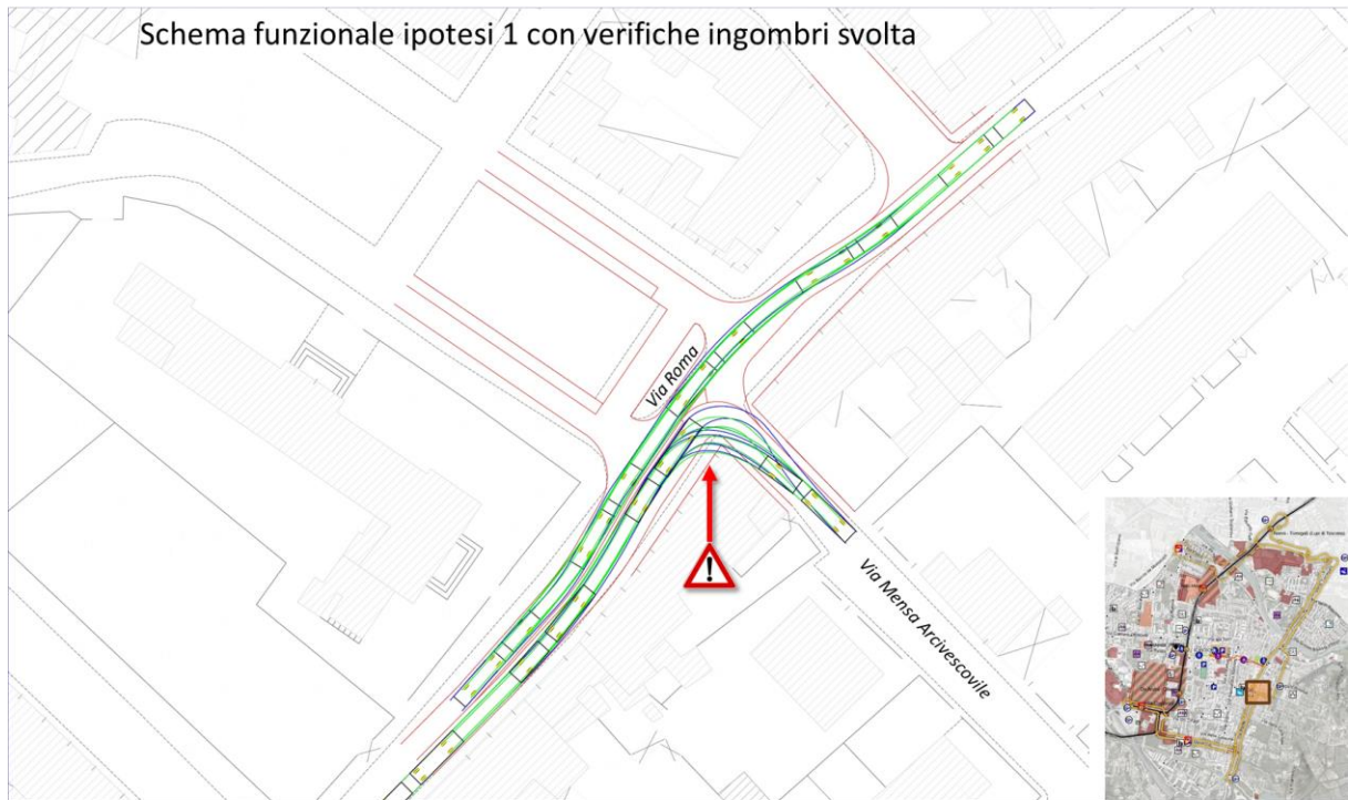
Figura 29 Schema funzionale con verifiche ingombri si svolta - Ipotesi 1
