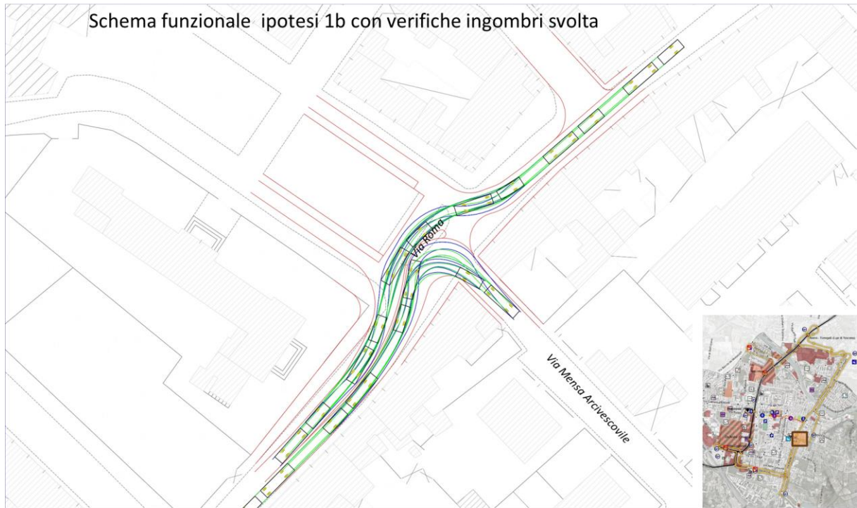
Figura 31 Schema funzionale con verifiche ingombri si svolta - Ipotesi 1b
