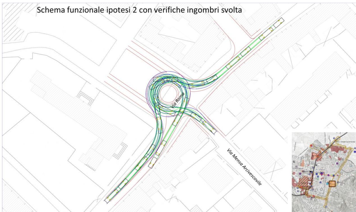
Figura 32 Schema funzionale con verifiche ingombri si svolta - Ipotesi 2
