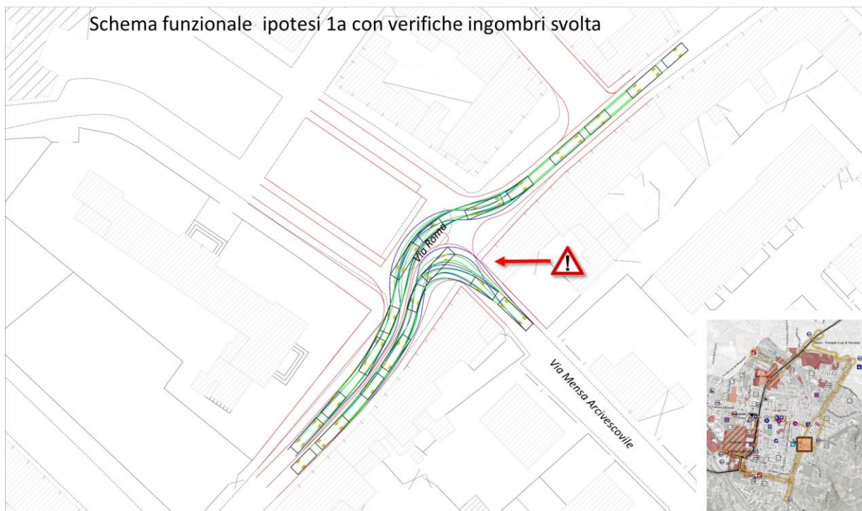
Figura 30 Schema funzionale con verifiche ingombri si svolta - Ipotesi 1a
